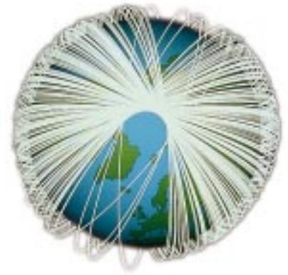
↑ La fragmentation d'un étage supérieur de fusée ou d'un satellite en orbite basse génère d'un seul coup beaucoup de nouveaux débris. Cette simulation montre qu'au cours des trois années qui suivent cette explosion, le plan orbital des débris ainsi générés évolue pour finalement recouvrir quasiment toute la planète. Photo ESA
