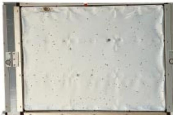
← L'analyse des panneaux du LDEF ont apporté de précieuses informations sur la résistance de certains matériaux aux impacts de micro débris et de micro météorites dans l'espace. Les principaux "trous" de cette fenêtre de test mise au point à l'Estec (ESA) avec le concours de l'université de Dublin (Irlande) résultent de tels impacts. Photo NASA
